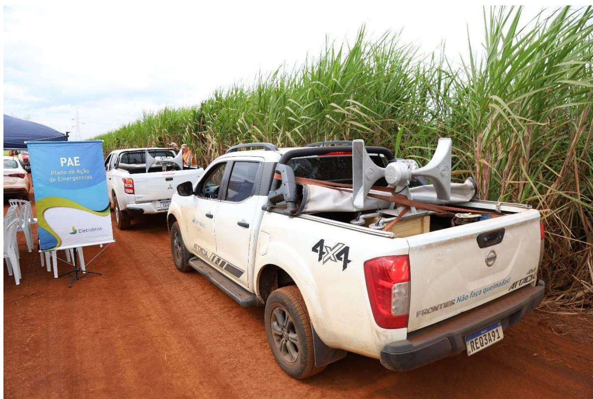
Figura 6 – Modelo de Sirenes Móveis instaladas em caminhonetes.
