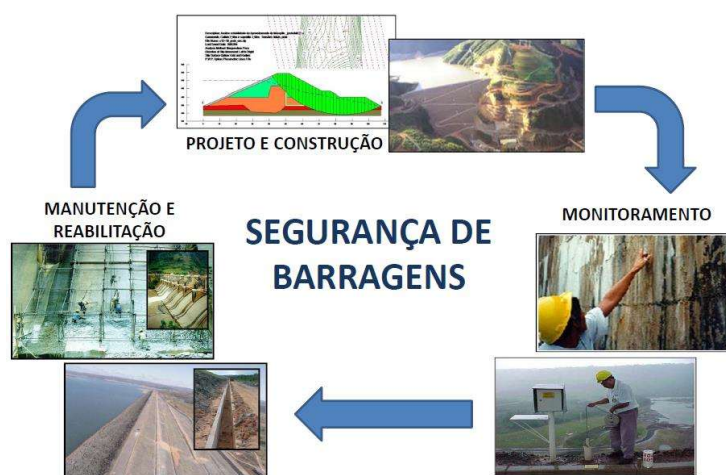
Figura 2 - Esquema da Segurança de Barragens
