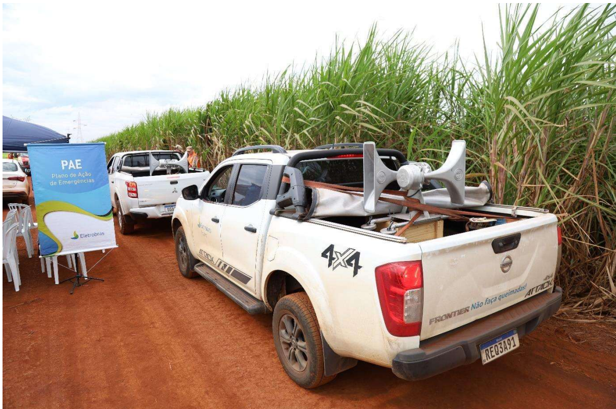
Figura 6 – Modelo de Sirenes Móveis instaladas em caminhonetes.
