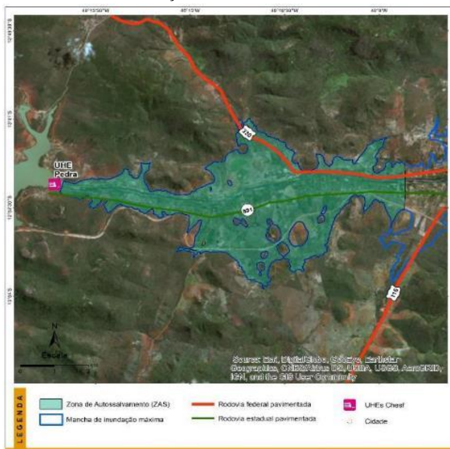
FIGURA 6.1 – IDENTIFICAÇÃO DA ZONA DE AUTOSSALVAMENTO – ZAS
