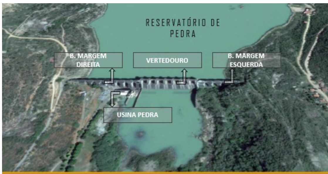
FIGURA 1 – ARRANJO GERAL DA USINA HIDRELÉTRICA PEDRA
