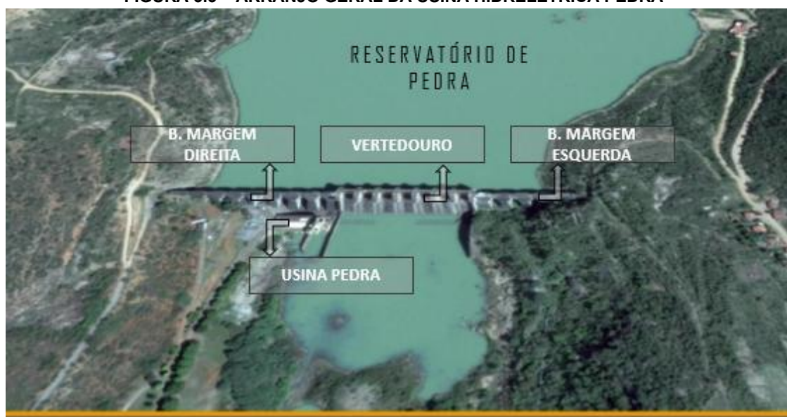
FIGURA 3.3 – ARRANJO GERAL DA USINA HIDRELÉTRICA PEDRA
