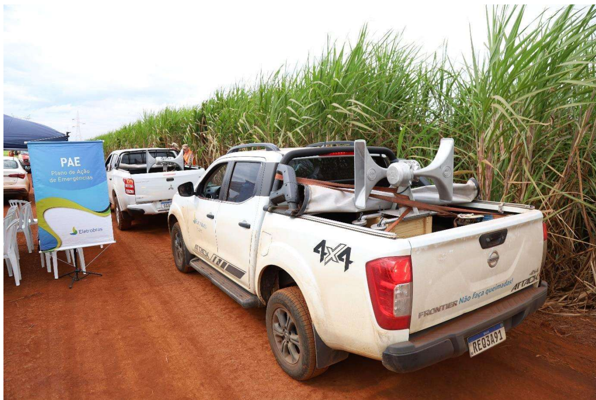
Figura 6 – Modelo de Sirenes Móveis instaladas em caminhonetes.
